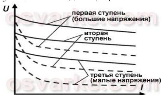
Рис.3 Регулирование вольт-амперных характеристик в сварочном выпрямителе ВДГ-302
