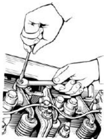
Рис. 4.2. Отвертывание контргайки регулировочного винта
