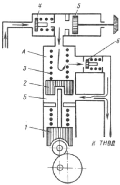
**Ручной топливоподкачивающий насос** предназначен для заполнения системы топливом и удаления из нее воздуха. Насос поршневого типа крепится к фланцу топливного насоса низкого давления через уплотняющую медную шайбу. Насос состоит из корпуса, поршня, цилиндра, рукоятки в сборе со штоком, опорной тарелкой и уплотнения.
